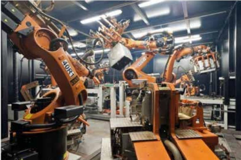
Zwei Schweißroboter schweißen die kritische drei Meter lange Schweißnaht – gratfrei, sodass keine weitere Behandlung erforderlich ist.
