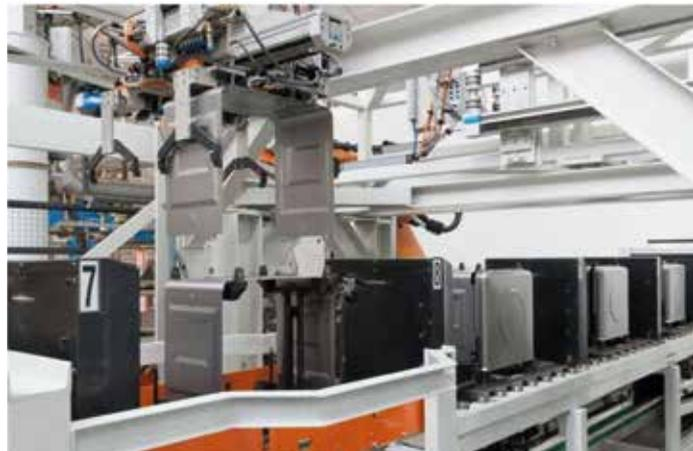
Die eigentliche Verbindung erfolgt in der hermetisch abgeschlossenen Schweißkabine. Mittels einer lenkbaren Kamera wird das komplexe Innenleben der Schweißkabine von außen beobachtet. Zwei Schweißroboter und vier Schneidroboter verarbeiten die Öfen. Roboterarme greifen die vorpositionierten Öfen. Die Spanntechnik fixiert die Ober-, Unter- und Garraum-Teile am Werkzeugträger.
