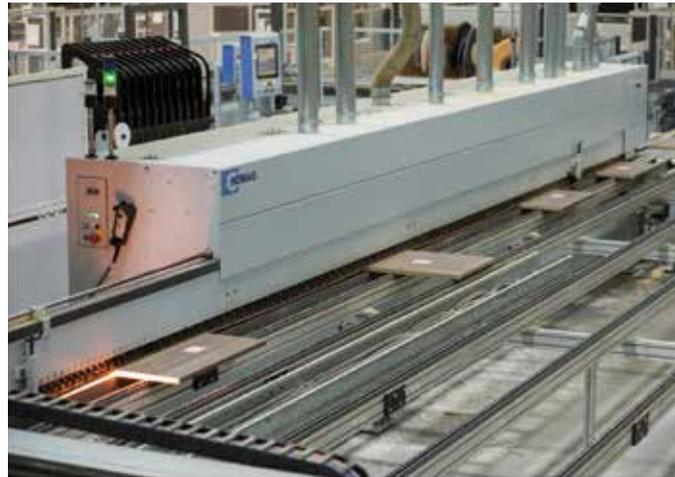
Danach kommt jede Platte wiederum eindeutig identifiziert in das zweite Pufferlager. Aus diesem Pufferlager werden die Teile, die bis zu diesem Zeitpunkt unabhängig voneinander und in beliebiger Reihenfolge gefertigt
