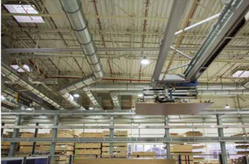
Unmittelbar nach den Sägen wird jedes Teil mit einem Barcode auf der Oberseite eindeutig identifiziert, wodurch alle nachgelagerten Maschinen, welche diesen Barcode lesen, erkennen, um welches Teil es sich handelt und wie es zu bearbeiten ist. Jedes Teil wird sodann einzeln und eindeutig identifiziert in das Pufferlager zwischen Säge und Kantenumleimer mittels CNC-gesteuerter Förderbänder und Förderkräne eingelagert:
