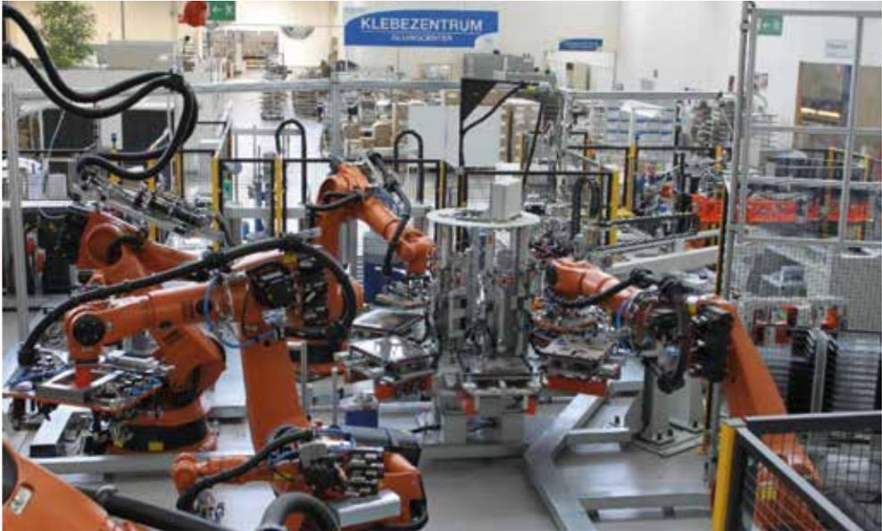
Der andere Bereich ist die Verpackung der fertigen Herde durch Verpackungsroboter.
