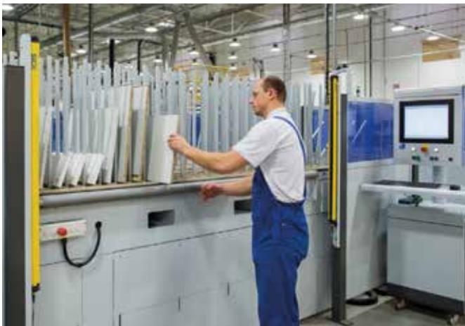
Auch die nun erfolgende Verpackung ist teilweise automatisiert. Für jedes Büromöbel werden die minimal erforderlichen Abmessungen des Verpackungskartons rechnerisch ermittelt und anschließend dieser Karton von einer CNC-gesteuerten Maschine ausgeschnitten und gefalzt. An den Verpackungsarbeitsplätzen wird sodann jedes Produkt, bestehend aus seinen Spanplatten-Teilen, seinen metallischen
