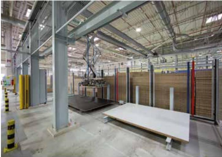
und Oberflächen. Diese beschichteten Spanplatten, welche unter anderem von österreichischen Lieferanten an Nowy Styl geliefert werden, sind der Anfangspunkt der Produktion wie auf dem Foto ersichtlich.
